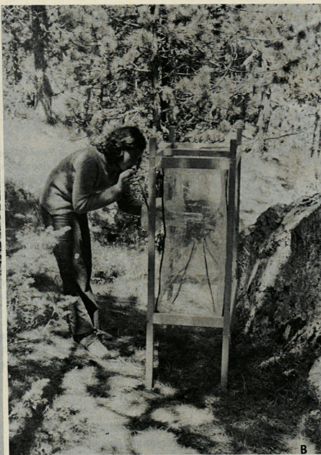
Fig. 1 B. — Pièges pour Culicides diurnes. Construit en plastique souple transparent, ce piège comporte dans sa partie inférieure, une nasse maintenue ouverte par deux élastiques; un pain de 200 grammes de carboglace placé dans un sac en plastique, est suspendu à son toit. Les Insectes piégés sont récoltés à l'aide d'un capteur à bouche.
