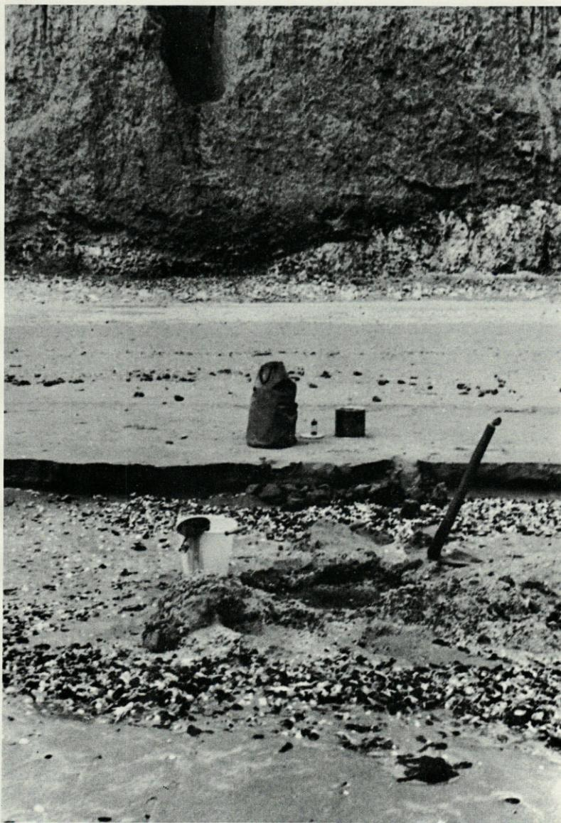
FIG. 3. — Năvodari, sondage 7. Sable hétérogène, avec couches de coquilles de *Cardium* qu'on peut observer près du trou.
